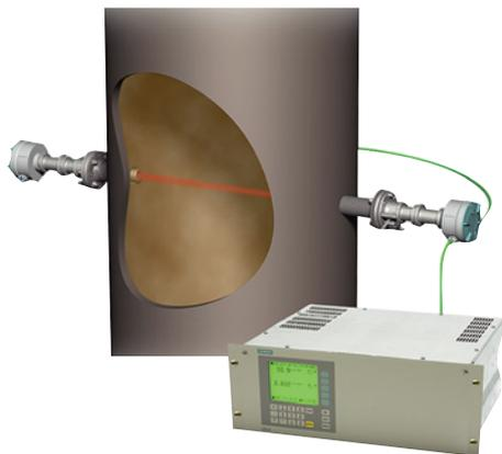
Газоанализаторы LDS 6 и Sitrans SL по принципу действия представляет собой высокоточный лазерный фотометр и предназначен для определения в «проблемных» газовых потоках компонентов, поглощающих излучение в инфракрасном диапазоне, а также для измерения содержания кислорода и температуры непосредственно в факеле.
